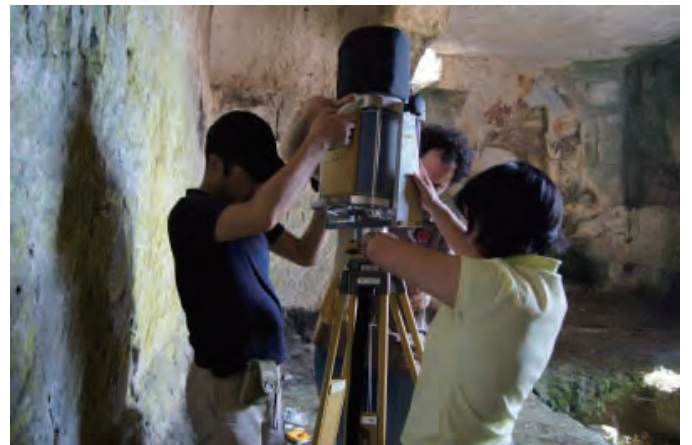
トプコンGLS-1500を三脚に設置するのは3人がかり
