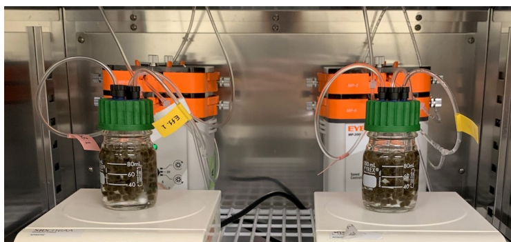
実験室で運転しているバイリアクター
